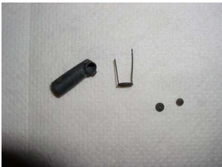
Foto 11 muestra el tubo de la chimenea ya soldado con plata con su correspondiente ángulo en la parte superior. También se muestra la tapa de la chimenea, que la he hecho de latón.
