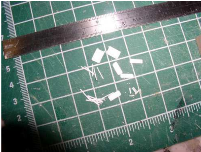
Foto 3 muestra el depósito de ceniza y las puertas del horno, las de acceso y las bisagras. Estas fueron hechas de acetato blanco, ya que es rígido y con un espesor adecuado. Con unas tijeras y una buena hoja de cutter se pueden obtener cortes en una sola pasada.
