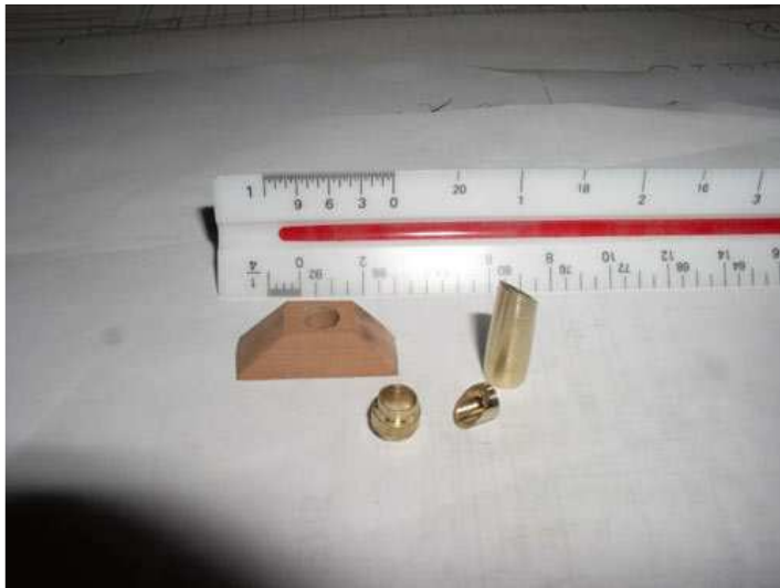
Foto 9 muestra las distintas partes de la campana y chimenea. He utilizado varilla de latón torneada para hacer las tres piezas que se muestran en la foto de esta cocina.
