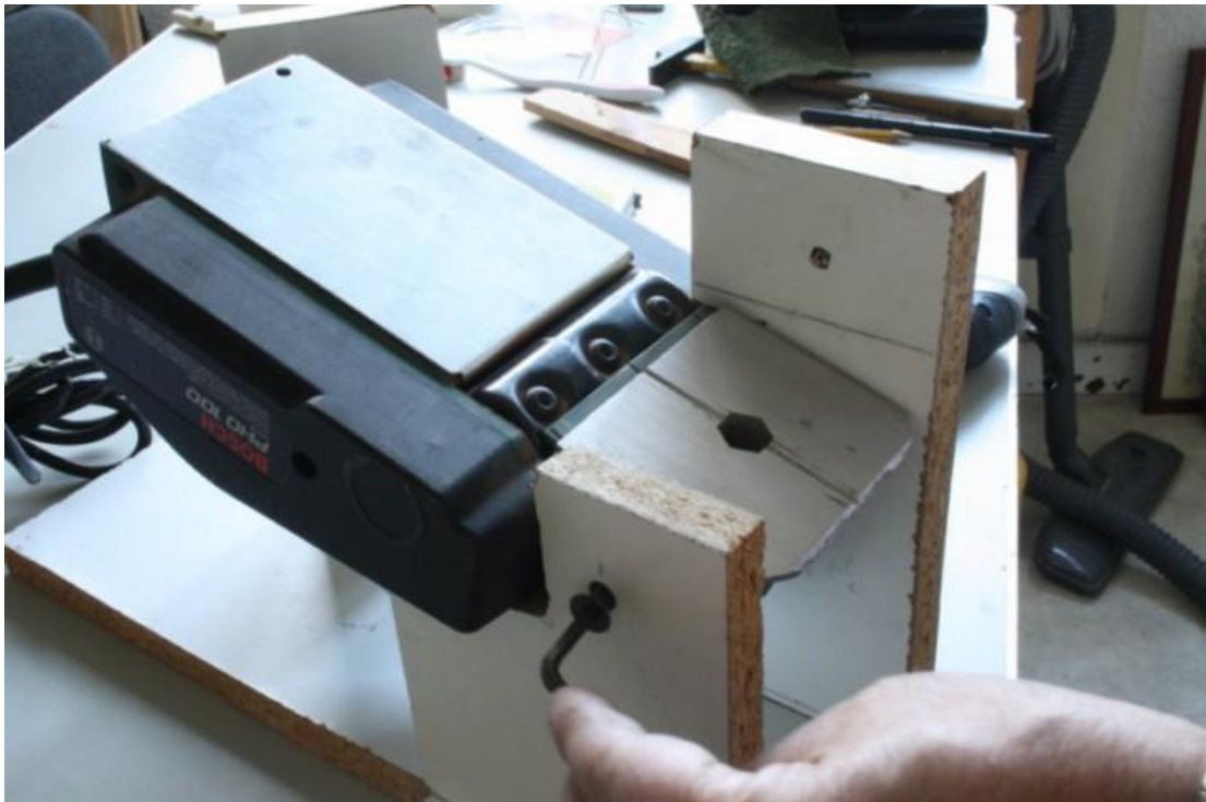
Fijación del cepillo al conjunto de madera
