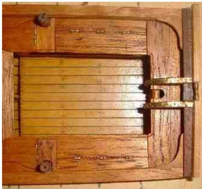
Vista de proa y popa de la tapa de regala, con el triángulo de cierre, sus refuerzos y sus molduras
