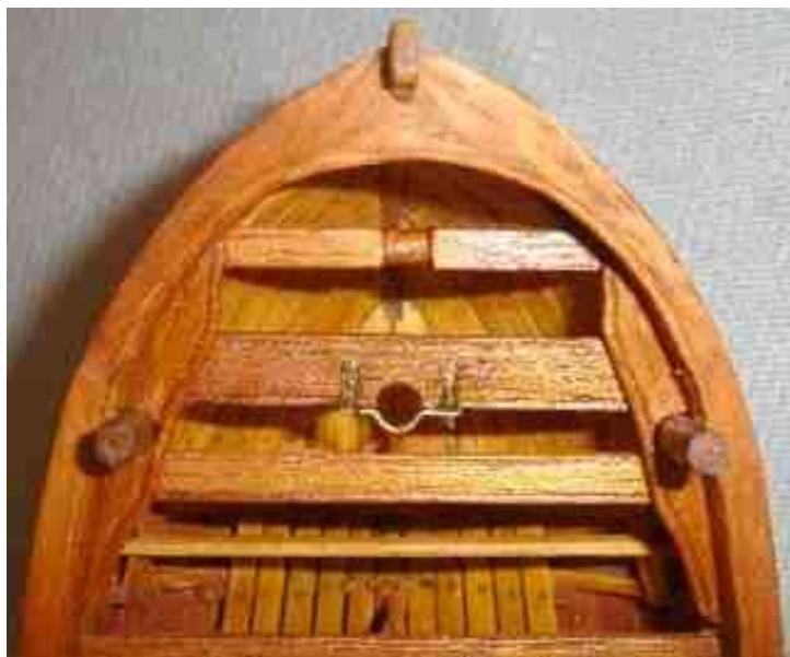
Vista de proa y popa de la tapa de regala, con el triángulo de cierre, sus refuerzos y sus molduras
