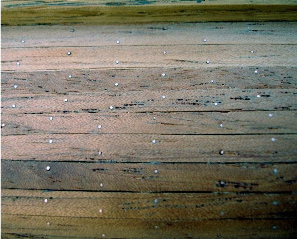
En esta foto podemos observar los clavos a nivel de la CM. Se nota el cambio de alineación dentro de la misma cuaderna, cuando clava la ligazón o la varenga.
