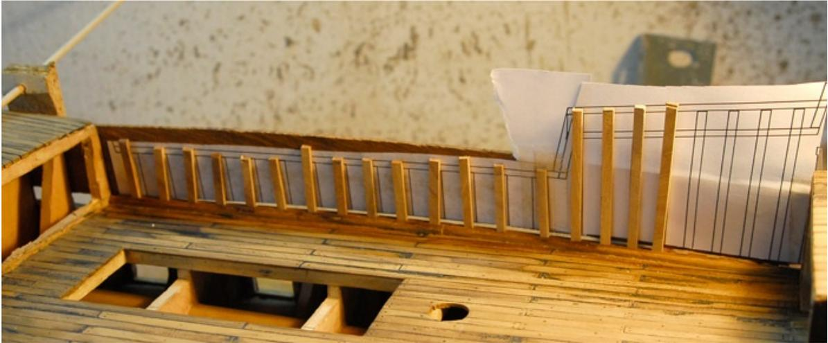
Me ayudo de una copia del plano para alinear y calcular la altura de los barraganetes. Luego completar la borda con las tracas y la tapa de regala.
