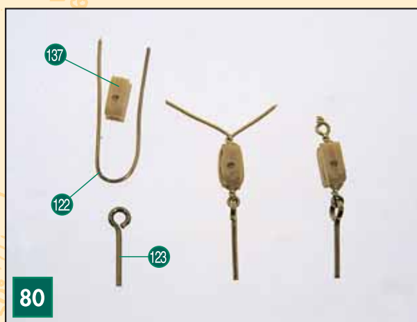
Gazas, vigotas y cadenotes Loops, deadeyes and chainplates / Erseaux, caps de mouton et cadènes Stroppe, Klampböcke und Püttingseisen / Lussen, jufferblokken en rustijzers Cappi, bigotte e landre / Estropos, bigotas e barretas
